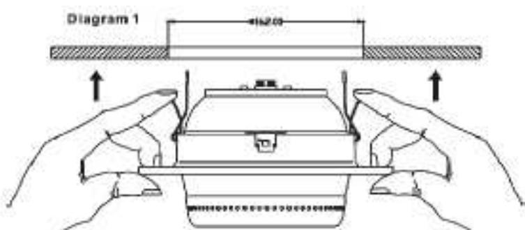
Après avoir installé l'appareil, assurez-vous d'une fixation ferme de l'appareil en tirant sur l'appareil. Vérifiez si les languettes sont bien posées contre la paroi de la surface de montage (voir ill. 2).
