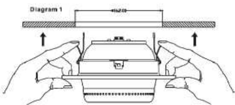
Después de haber instalado el aparato, verifique si el aparato está firmemente fijado al tirar del aparato. Verifique que las lengüetas estén bien puestas contra la superficie de montaje (véase fig. 2).
