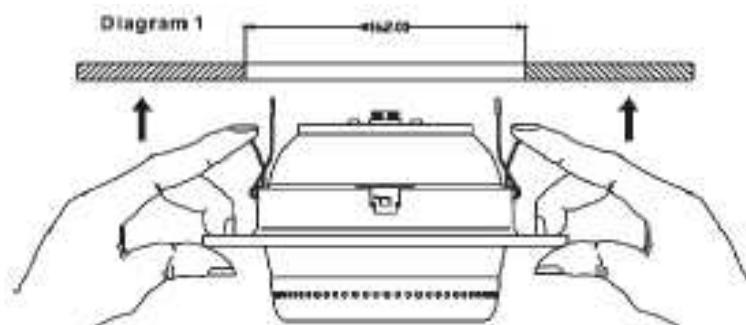
Überprüfen Sie nach der Installation, ob die Vorrichtung gut festsitzt. Versuchen Sie einige Male die Vorrichtung auszuziehen und sorgen Sie dafür, dass die Sicherheitsclips gegen die Oberfläche gedrückt sind (siehe Abbildung 2).
