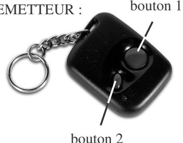
3. Appuyez le bouton I de l'émetteur et maintenez-le enfoncé jusqu'à ce que l'alarme émette un bip de confirmation. La programmation est faite.
