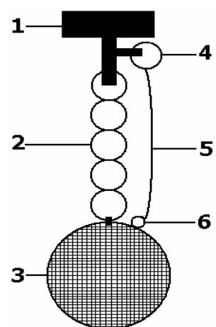
Sicherheitskabel (5). Achten Sie darauf, dass das Sicherheitskabel sicher an den Ringen (4 & 6) befestigt ist und ein wenig länger als die Kette der Spiegelkugel ist (2).
