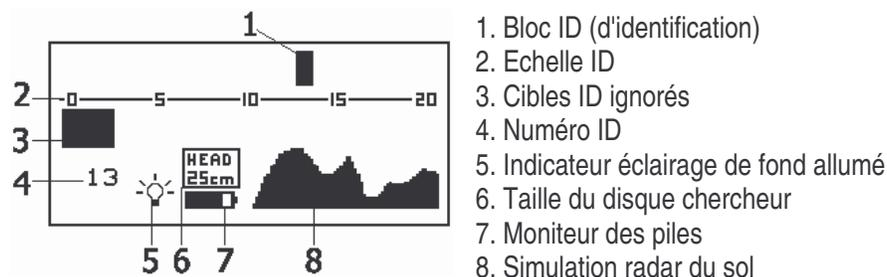
Simulation radar du sol: ce radar défilant en continu est une visualisation du signal reçu par le **CSR1**. Elle peut être utilisée comme outil supplémentaire pour analyser des signaux est elle est très utile pour la localisation précise des objets. Elle est visible aussi bien en mode de recherche que quand les menus sont affichés. La sensibilité du radar est contrôlée par le réglage Pin Point Gain.
