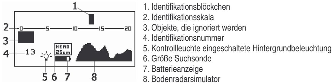
**Bodenradarsimulator:** dieser ständig rollende Radar gibt die Signale, die der **CSR1** empfängt, wieder. Dieser Bodenradar ist ein Hilfsmittel um Signale zu analysieren und ist vor allem handlich um den genauen Ort, an dem sich Objekte befinden, zu bestimmen. Auch beim Abrufen des Menüs ist der Radar sichtbar. Die Empfindlichkeit wird durch die 'Pinpoint-Einstellung' bestimmt.
